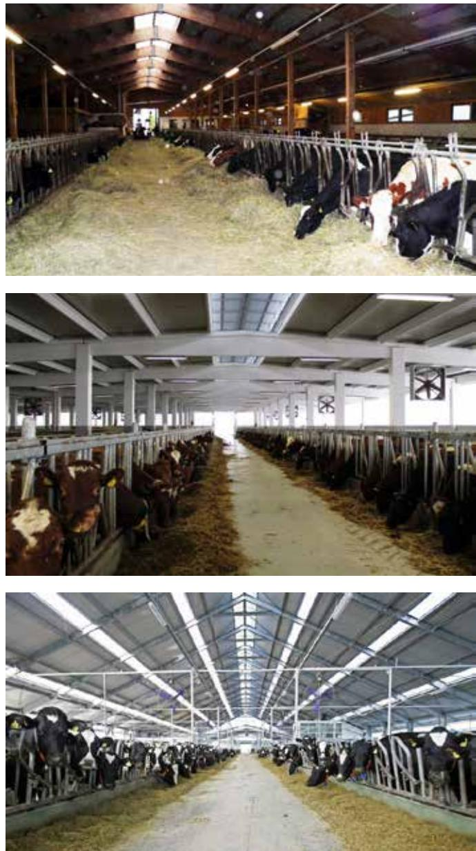
Slika 28. Linijske krovne konstrukcije: drveni nosači, Austrija, 2013; betonski nosači, Trnopolje (BiH), 2014. i čelični nosači, Darda (Hrvatska) (Izvor: Autori, gore; Autori, sredina i JaTrgovac.com, dolje)
