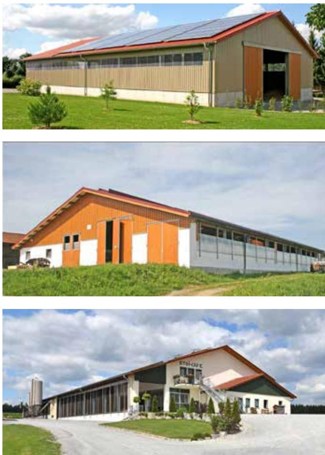
Slika 17. Tipovi staje za krave prema izgrađenosti obodnih zidova: zatvoren, poluotvoren ili otvoren
