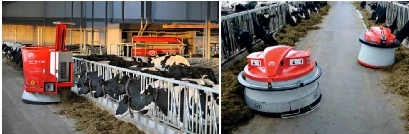
Slika 46. Lely Vector robot za TMR ishranu i robot Hetwin Automation Systems GmbH za primetanje hraniva na krmni sto (Izvor: Lely Industries N.V., 2012, lijevo i JJ Limited, desno)
